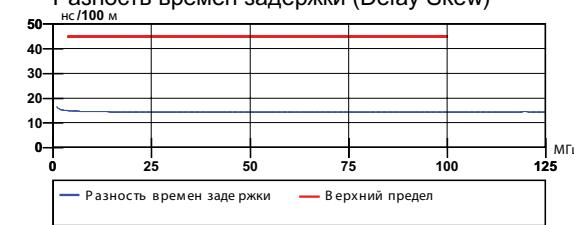
Протокол испытаний на кабель ParLan® F/UTP Cat 5e
