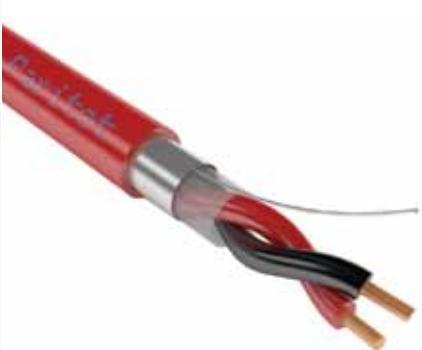
**КСРВнг(А)-FRLS** – кабель пучковой или парной скрутки с медными однопроволочными жилами, с изоляцией из керамизирующейся кремнийорганической резины, в оболочке из ПВХ пластиката пониженной пожарной опасности с низким дымо- и газовыделением.
