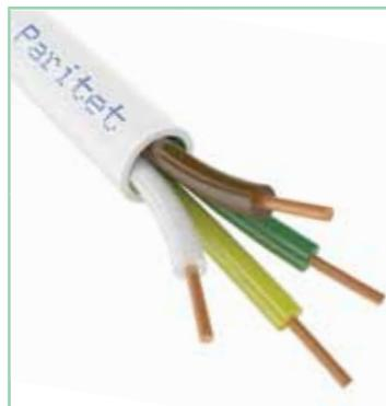
Кабели пучковой или парной скрутки, с медными или медными лужеными однопроволочными или многопроволочными жилами, с изоляцией из ПВХ пластика, или ПВХ пластика пониженной пожарной опасности с низким дымо- и газовыделением, или полиэтилена, в экране или без экрана, в защитной оболочке из ПВХ пластика или ПВХ пластика пониженной пожарной опасности с низким дымо- и газовыделением.
