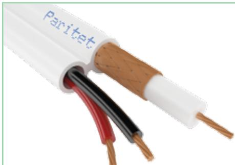
**ККСВ\*** - кабель с одним однопроволочным радиочастотным элементом и группой жил питания, выполненными из медной мягкой проволоки в изоляции из поливинилхлоридного пластика, в общей оболочке из поливинилхлоридного пластика с разделительным основанием между радиочастотным элементом и группой жил питания. Цвет оболочки белый.
